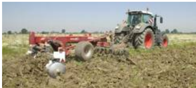
■ La seconda parte del test è stata eseguita con un erpice a dischi Jean de Bru Monoliner Vrm, un attrezzo che richiede velocità e buon traino.
