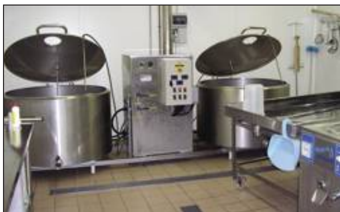
[ 3 - L'interno di un bel minicaseificio con doppie caldaie da 400 litri (Foto F. Crippa-Min.Bortoli Gorla M.- Va)
