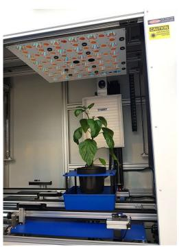
Il sistema Robin PSI PlantScreen<sup>TM</sup> è un dispositivo autonomo e può essere utilizzato per "fenotipizzare" digitalmente singole piante in vasi fino a 50 cm di altezza o in vassoi con max. 20 piccole piante, ad esempio Arabidopsis per una serie di caratteri. Il Robin PSI può essere facilmente trasferito in una camera climatica o in un compartimento della serra, per consentire un facile accesso dagli esperimenti in corso. Il Robin PSI è dotato di tre sensori:
