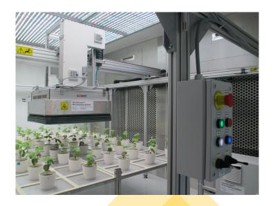
Il Modular System PlantScreen<sup>TM</sup> è una soluzione robotica integrata per la fenotipizzazione digitale ad alta precisione delle piante e la coltivazione di piante più grandi come mais o grano durante l'intero ciclo di vita. Il singolo vaso è posto in un disco di trasporto, che può essere dotato di diversi tipi di supporti per alloggiare vasi di diverse dimensioni.
