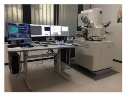
Lo strumento con sorgente ad emissione di campo è dotato di numerosi detectors e può essere utilizzato con diverse modalità di lavoro in condizione di basso vuoto (Variable Pressure) fino a 500 Pa. È dotato di un modulo Microanalisi EDS, OXFORD EDS Oxford Aztec Live con Detector Ultim Max 100, ce permette la mappatura elementare del campione.
